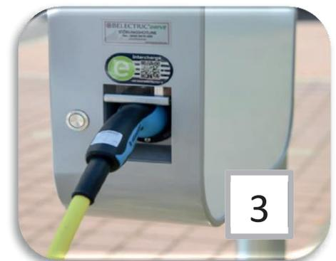
\*Nach DIN EN 61851-22 ist die Verwendung einer Verlängerungsleitung nicht erlaubt. Nach IEC 60884-2-5; IEC 62196-1 sind Adapter nur dann zulässig, wenn sie vom Hersteller der Ladestation oder des Fahrzeuges zugelassen sind. Desweiteren müssen nationale Vorschriften eingehalten werden. Ist eine zusätzliche Ventilation während des Ladens gefordert, so ist Laden nur erlaubt, wenn für Belüftung gesorgt ist. Anleitungen für den Anschluss des Elektrofahrzeuges an Ladestationen sind zu beachten.
